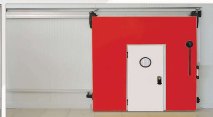
درب کشویی فریم لس با یک درب لولایی یا کشویی کوچکتر در داخل آن که به جهت جلوگیری از هدر روی انرژی، رفت و آمد افراد از درب کوچک صورت می گیرد.
